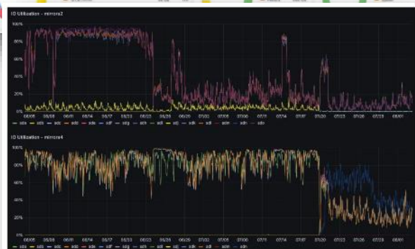
重建前后两台服务器的磁盘负载比较 左边为重建前，中间为仅 Rsync 服务器重建后，右边为两台服务器均重建后的负载
