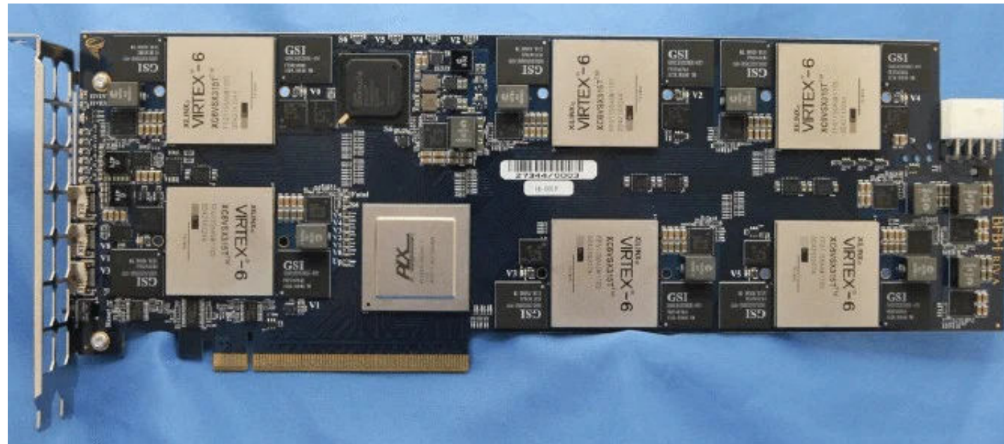
图：一块FPGA加速卡，用于计算加速辅助处理 使用Xilinx的Virtex-6系列FPGA
